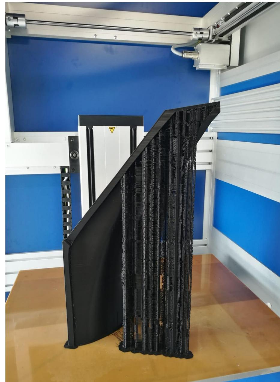
*Fertig gedruckte Formhälfte*
