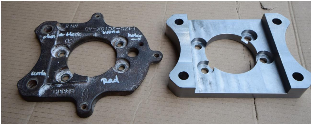
*Originalbauteil und modifiziertes Bauteil mit Aufnahme für 2 Bremszangen*
