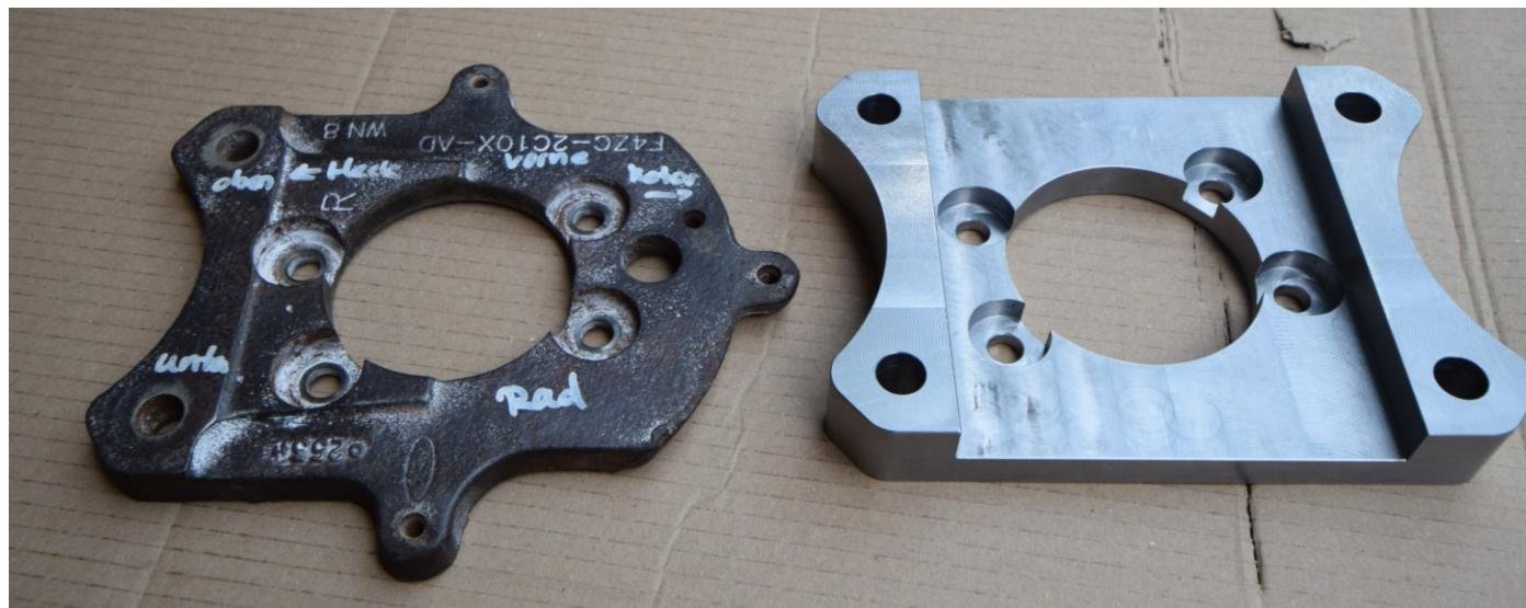
Rechts abgebildet ist das fertige Resultat, welches mithilfe von 3D-Scan, 3D-Druck und CNC-Fertigung hergestellt wurde.
